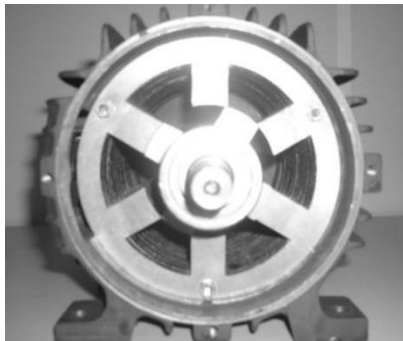
Figura 3. Máquina a relutância variável usada para obtenção dos parâmetros para a simulação.
