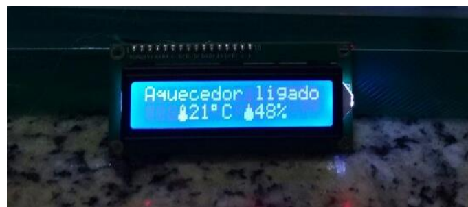
Figura 10 - Execução do comando pelo Arduíno e informação da temperatura e umidade, respectivamente.
