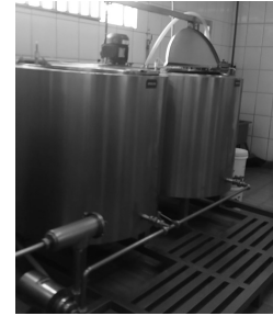
Fig 1. Caldeira para mistura e processo de temperatura
