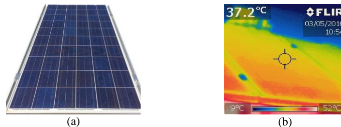
Fig. 5. a. Fotografia do módulo 4A - TPB156-60-P 235W sem a presença de formas de degradação visíveis a olho nu. b. Imagem termográfica do módulo 4A - TPB156-60-P 235W.
