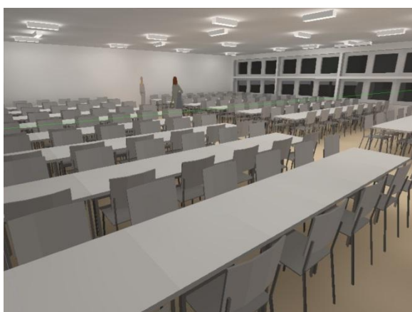
Fig. 9. Simulação DiaLux de parte do refeitório com iluminância média de 150 lux.
