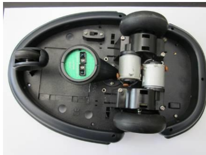
Fig. 2. Vista inferior do chassi Eaglemoss utilizado no robô
