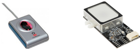
Fig. 6. Dispositivos aquisitores de imagem de biometria digital - Leitor Biométrico Digital Persona Are U (à esquerda) Scanner biométrico GT-511C1R (à direita).
