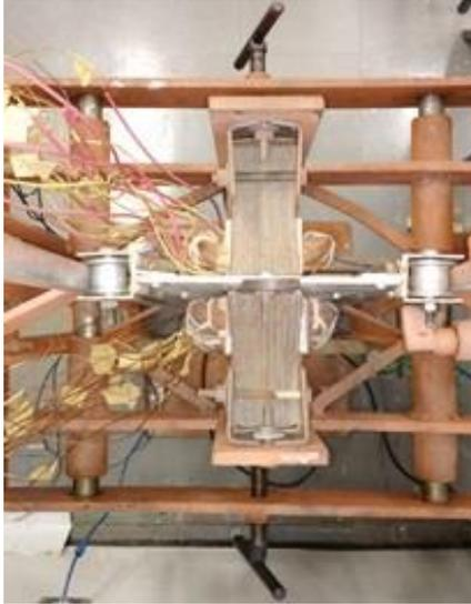
Fig. 2. Vista superior do Motor de Indução Linear
