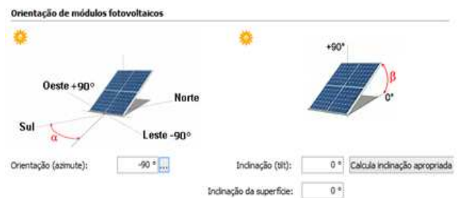
Fig. 4. Tela parcial do SOLergo para simulações das orientações e inclinações.
