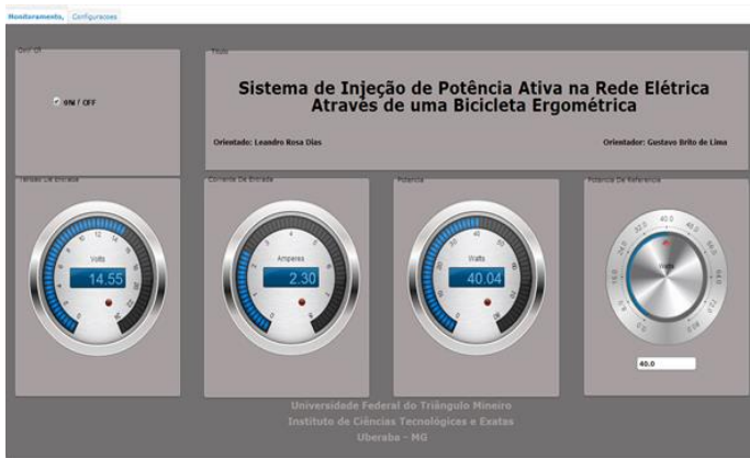
Fig. 6. a) Interface visual onde se estipulou a potência de referência em 40 W e acompanhou-se a tensão, corrente e potência ativa gerada. b) Formas de onda da tensão, corrente e potência ativa obtidas pelo osciloscópio.
