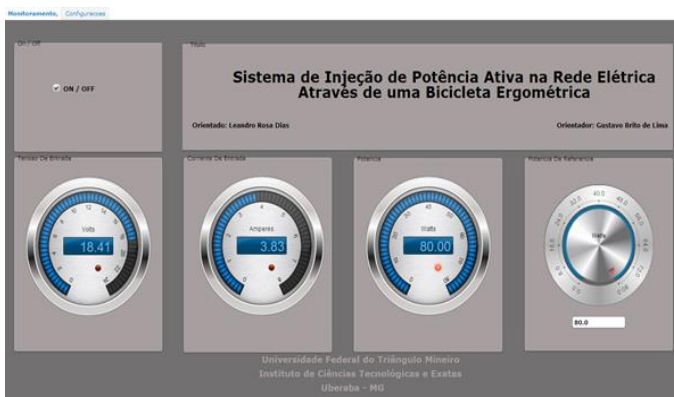
Fig. 7. a) Interface visual onde se estipulou a potência de referência em 80 W e acompanhou-se a tensão, corrente e potência ativa gerada. b) Formas de onda da tensão, corrente e potência ativa obtidas pelo osciloscópio.
