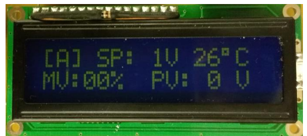
Fig. 7. Tela de monitoria do Set Point, MV, PV e temperatura do estator da máquina síncrona.
