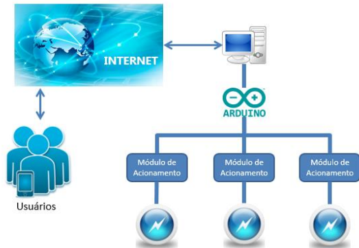
Fig. 2. Arquitetura Arduino com comunicação serial.
