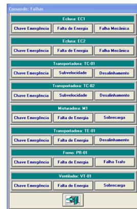
Fig. 4. Janela de comando: falha.
