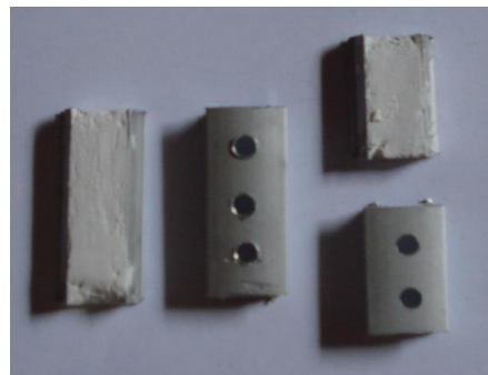
Fig. 7. Encaixe para os led's com e sem acabamento em gesso.
