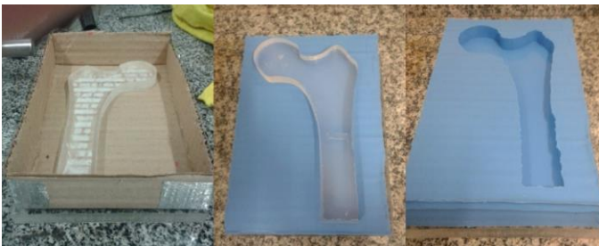
Fig. 1. Molde de silicone gerado, a partir de modelo em acrílico, apoiado em desempeno, para confecção de modelo fotoelástico.
