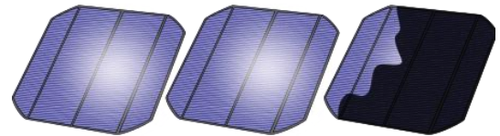
Fig. 14. Sombreamento parcial de um sistema de módulos.
