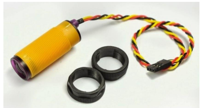
Fig. 2. Sensor de proximidade infravermelho utilizado
