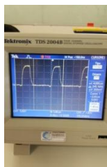
Fig.2. Osciloscópio mostrando a forma de onda dos pulsos do circuito integrado do driver da lâmpada LED
