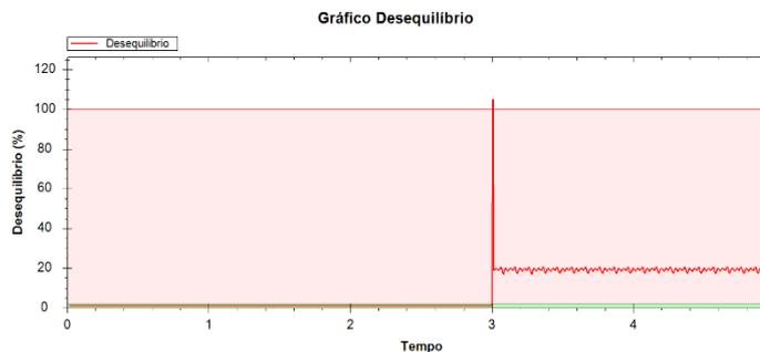
Fig. 9: Desequilíbrio de tensão causado pela máquina de solda.
