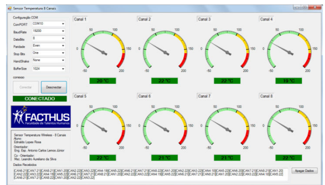
Fig. 13. Sistema supervisor recebendo informações vindas da placa conversora analógica digital.
