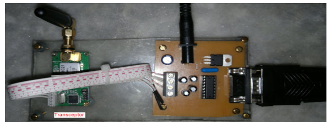
Fig. 7. Transceptor SRWF 1021 ligado ao módulo de comunicação com o computador.
