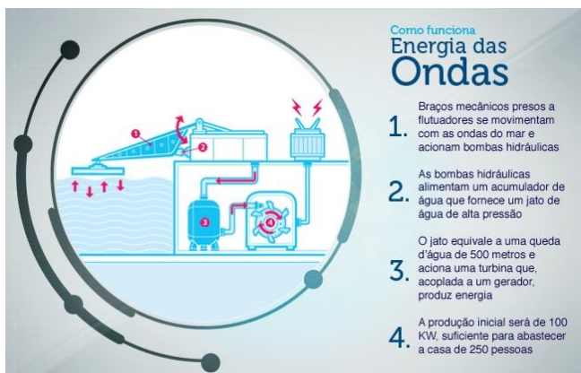
Fig. 10. Esquema de funcionamento da usina do Pecém.
