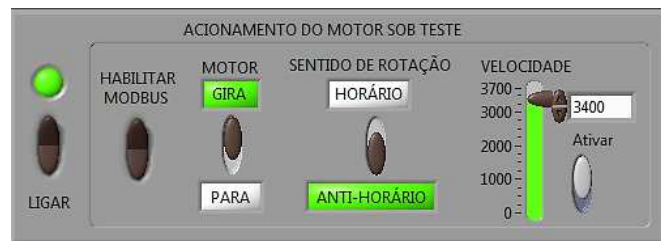
Fig. 8. Detalhe da parte do sistema supervisão implementada para executar o acionamento do MIT.
