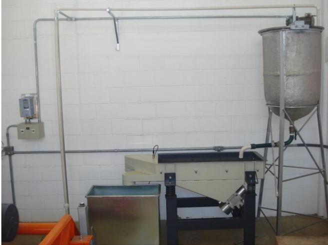
Fig. 4 Unidade de recuperação de fluido de perfuração
