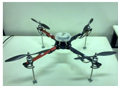
Fig. 1. Estrutura do quadricóptero.
