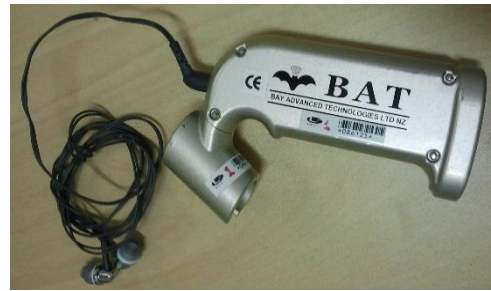
Fig. 2. Dispositivo ultrassonoros denominado K-Sonar.
