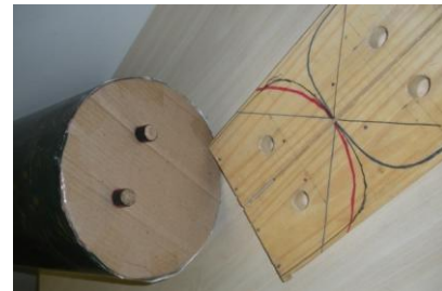
Fig. 10. Detalhe dos pinos e furos que servem de guia para o posicionamento correto do objeto durante os experimentos.
