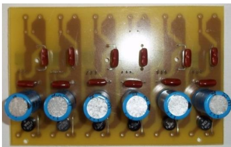
Fig. 16. - Montagem da placa de alimentação.
