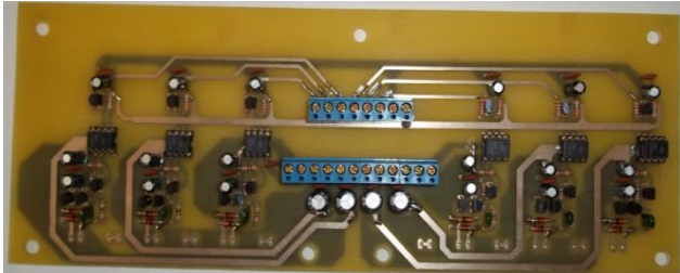
Fig. 15. - Montagem da placa de controle e potência.
