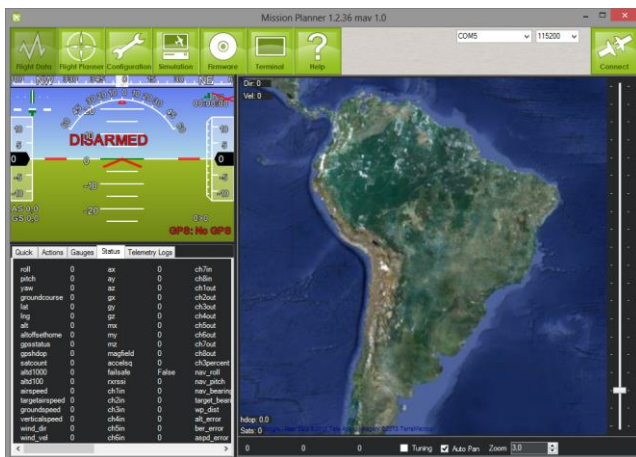
Fig. 10. Tela de visualização dos dados da aeronave (telemetria).
