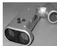
Fig. 3. Dispositivo com sensores ultrassônicos conhecido comercialmente como K-Sonar.
