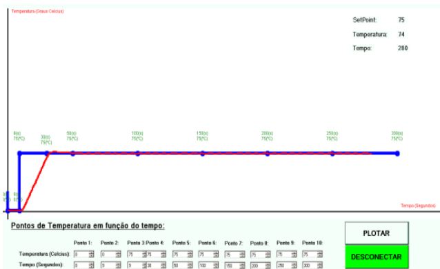
Fig. 4. Resposta do sistema com controle PID.
