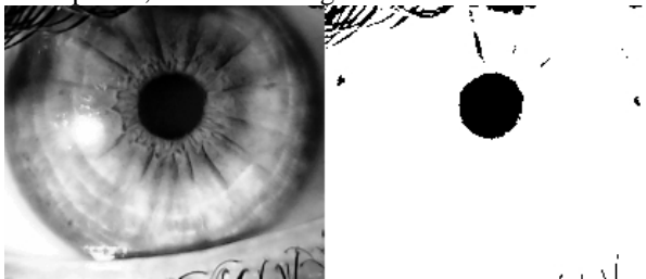
Figura 4: Imagem com equalização de histograma e binarizada com um limiar de 15.
