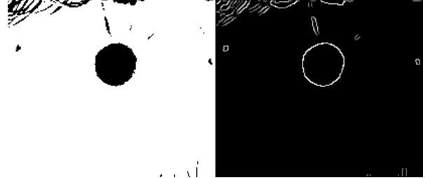
Figura 5: Imagem binarizada e bordas detectadas pelo método Canny.
