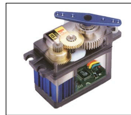
Fig. 3. Servo motor utilizado no controle de direção do protótipo do self-parking car.
