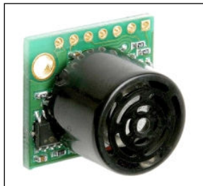
Fig. 1. LV-MaxSonar® - EZ0™, sonar de alto desempenho, transdutor responsável por medir a distância entre as vagas e a distancia que o protótipo se encontra com relação aos outros veículos.
