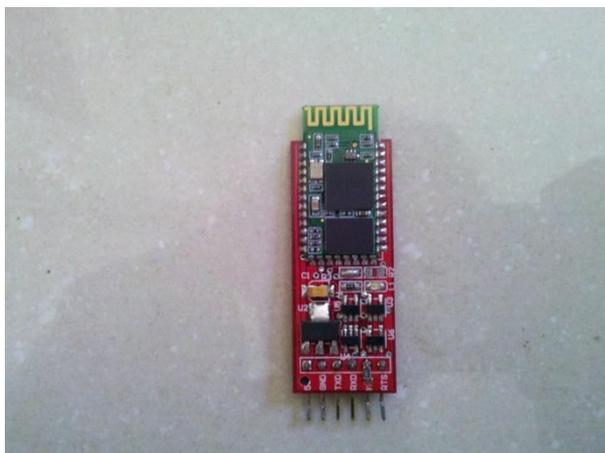
Figura 5 - Módulo bluetooth utilizado
