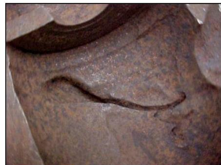
Fig. 1. Válvula *choque* mostrando região onde predomina a erosão.
