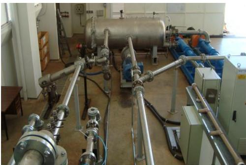
Fig. 3. Circuito de testes para ensaios de corrosão e erosão.
