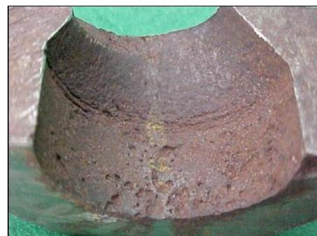
Fig. 2. Válvula *choque* mostrando região onde predomina a corrosão.
