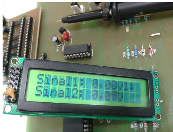
Fig. 5. Valores da tensão do sinal amplificado e exibido no display LCD alfanumérico
