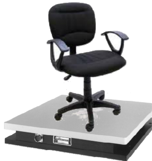
Fig. 2. Representação da cadeira acoplada a Plataforma de Força.
