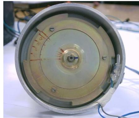
Fig. 12. Posicionamento real do disco e do sensor óptico.
