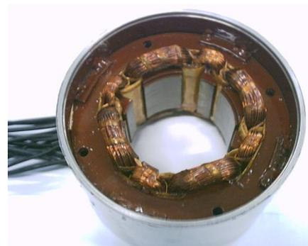
Fig. 2. Estator do motor utilizado no projeto.
