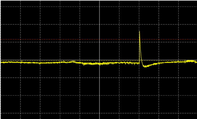
Figura 8 – Sinal de descarga parcial gerada pelo calibrador de pulso.
