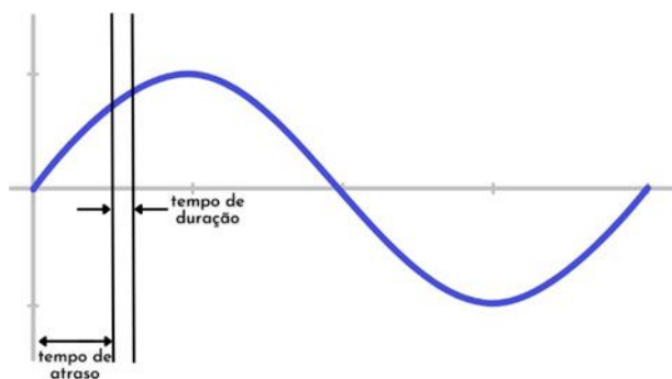
Figura 5- Processo de segmentação do sinal.
