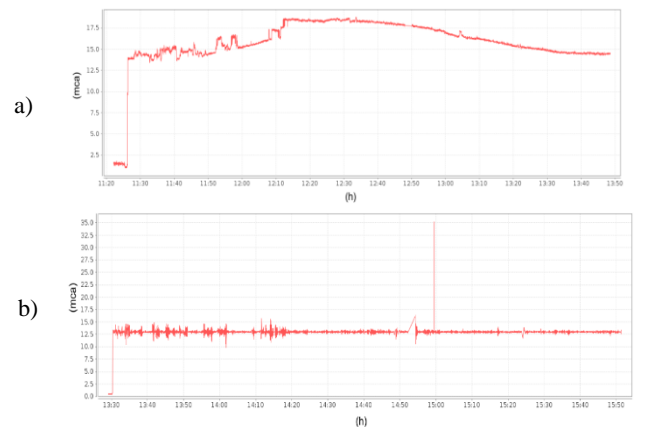
Figura 14: Vazão sem controle de pressão (a) e com controle de pressão (b)
