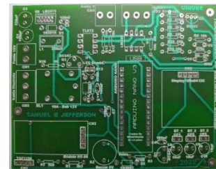
Figura 7: (a) PCI após fabricação, sem componentes (b) Montagem de componentes na PCI
