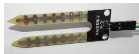
Figura 11: Corrosão no sensor energizado em período contínuo (visão traseira). Fonte: Autores (2023).
