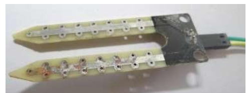
Figura 11: Corrosão no sensor energizado em período contínuo (visão traseira). Fonte: Autores (2023).
