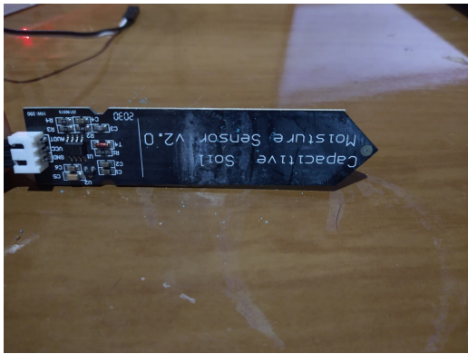
Figura 10: Oxidação do sensor capacitivo.
