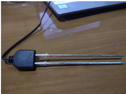
Figura 11: Oxidação do sensor resistivo resistente.
