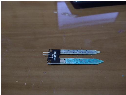
Figura 9: Oxidação do sensor resistivo de baixo custo.
