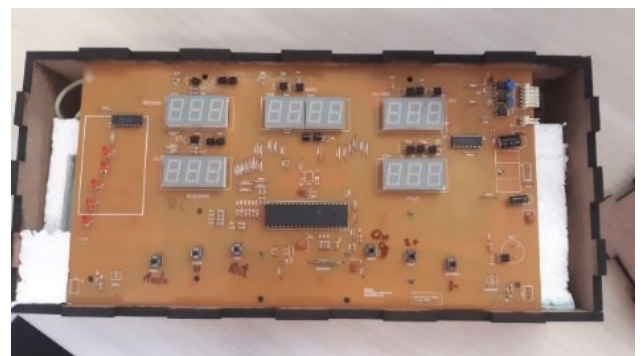
Figura 10: Nova estrutura (fechada) para comportar a placa de controle
