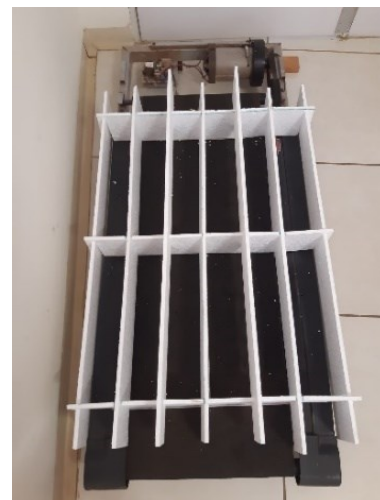
Figura 5: Esteira com simulação das divisões de baias e proteção.
