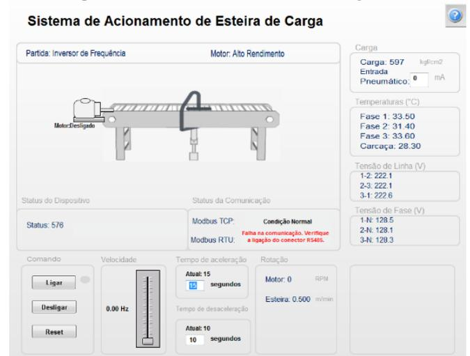
Na parte inferior da figura 15 estão os comandos referentes ao elemento de partida e ao motor. O elemento de partida é acionado por meio dos botões “Ligar”, “Desligar” e para caso de falha, há o botão “Reset”.
