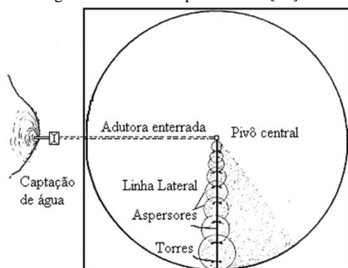
Figura 1: Sistema de pivô central [14].
