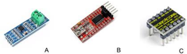
Figura 4: Componentes utilizados e citados na seção de metodologia do trabalho. (a) Conversor de dados TTL para RS-485; (b) Conversor USB Serial FT232RL FTDI para RS-232; (c) Conversor de Nível Lógico RC;
