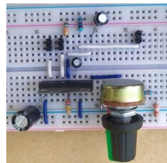
Figura 9: Circuito amplificador diferencial
