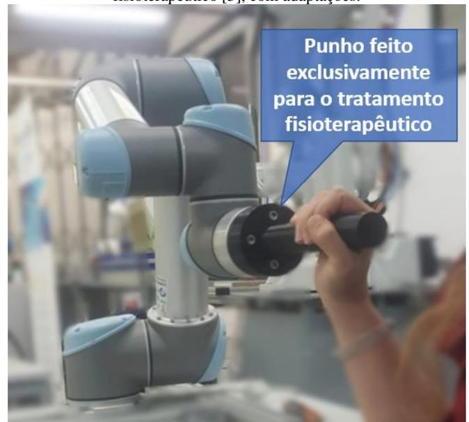
Conforme [3], apesar de esta aplicação ainda ser experimental os resultados são positivos. Por ser uma aplicação recente necessita de algumas melhorias e adaptações, entre elas calibrar o braço do usuário diretamente no programa do robô, antes de iniciar os exercícios e utilizar um sistema de visão para detectar as articulações e adaptar os exercícios a localização do paciente.
