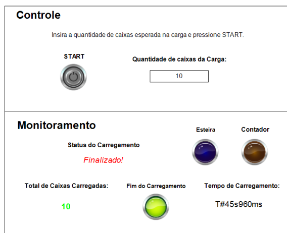
Figura 6 - Sistema Supervisório após o fim do carregamento.
