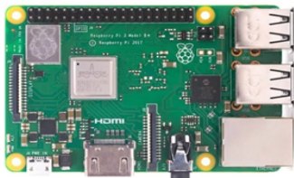
Figura 5: Microcomputador Raspberry Pi 3 B+
