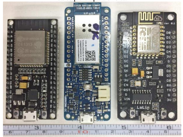
Figura 1: Plataformas de desenvolvimento de sistemas microcontrolados: ESP32, MKR1000 e ESP8266, da esquerda para direita.
