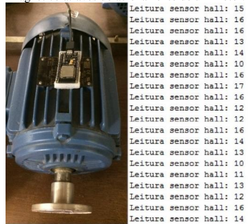
Figura 7: Leituras do sensor hall com a aplicação de campo magnético através do acionamento de um motor.
