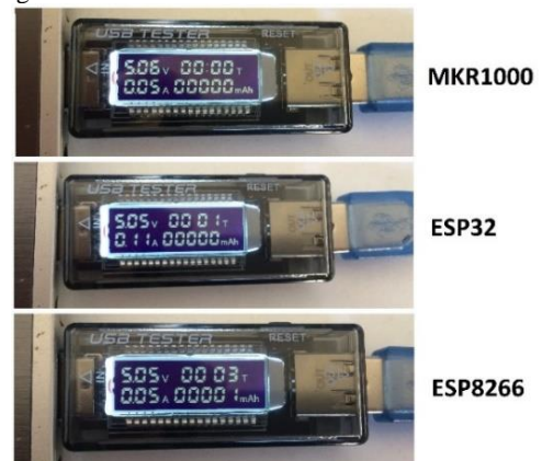
Figura 4: Teste de consumo utilizando o USB Tester.
